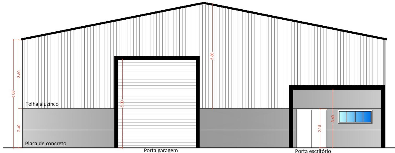
→ Telha trapezoidal, TP 33, simples, cor cinza (largura útil 1050 mm).
